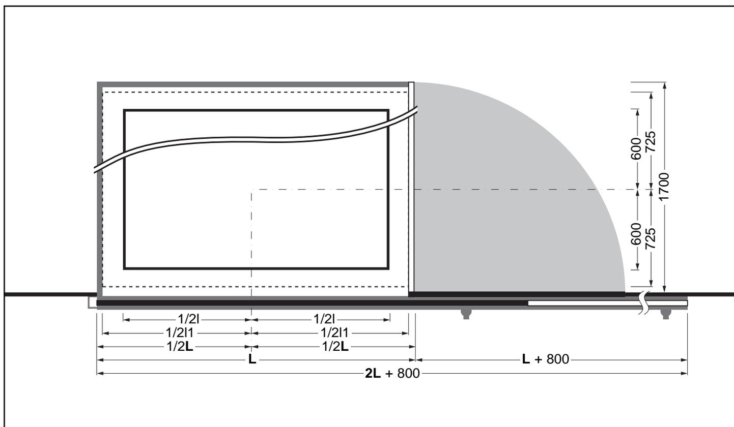
**5** Barrière pour charges volumineuses, hautes ou suspendues. Garde-corps coulissant à droite, portillon ouvrant à gauche.
